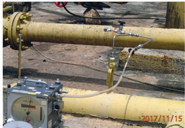
**Gambar** Pengambilan Sampel Air dan Gas untuk Mengetahui Kandungan Merkuri
