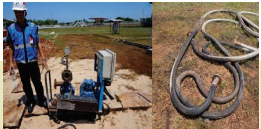
Gambar 4 : Pompa portable (kiri), Hose yang digunakan (kanan)
