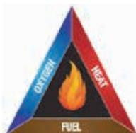
Kebakaran terjadi karena adanya tiga unsur segitiga api, yaitu sumber bahan bakar, sumber panas, dan Oksigen. Bahan bakar bersumber dari cairan Hidrokarbon yang menyembur melalui lubang anulus yang dalam kondisi terbuka untuk kegiatan pemasangan ESP. Cairan beserta gas menyebar dengan cepat ke sekitarnya mencapai sekitar 10 meter. Gas ini membentuk campuran yang mudah meledak (*explosive mixture/explosion limits*) dengan Oksigen dan tinggal menunggu unsur ketiga, yaitu sumber penyalakan.
