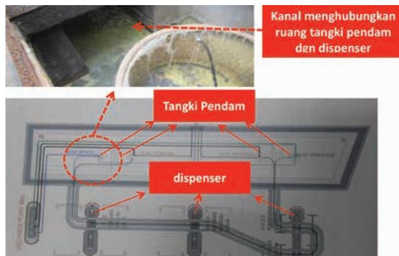
Gambar 8 : Lay-out kanal penyaluran BBM
