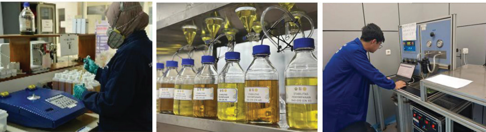
Gambar 2.12 Pelaksanaan Pengujian Karakteristik Bahan Bakar Nabati Biodiesel B50
