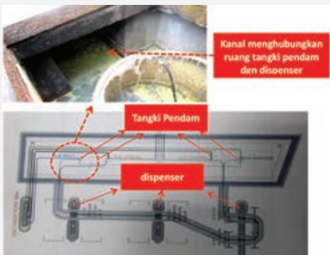
Gambar 8. Lay-out kanal penyaluran BBM
